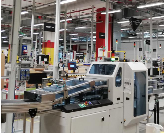
Figure 7 : Photographies d'une ligne d'impression à jet d'encre (gauche) et d'une machine de découpe finale du livre (droite)
