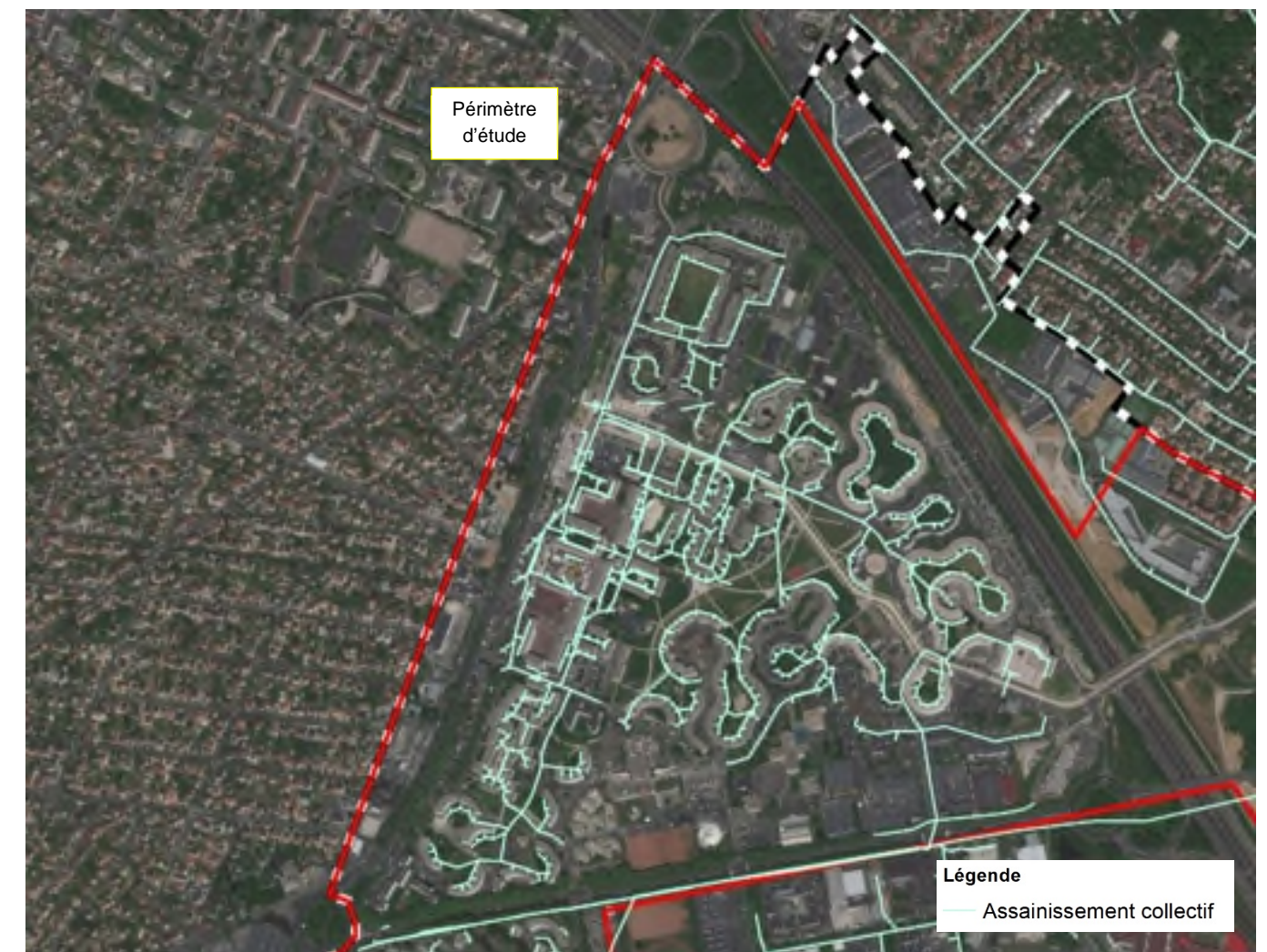
Figure 90 : Réseau d'assainissement au sein du périmètre d'étude
