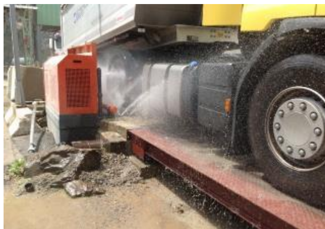
Décrotteur de roue avec jets Source : http://www.wheelclean.fr
