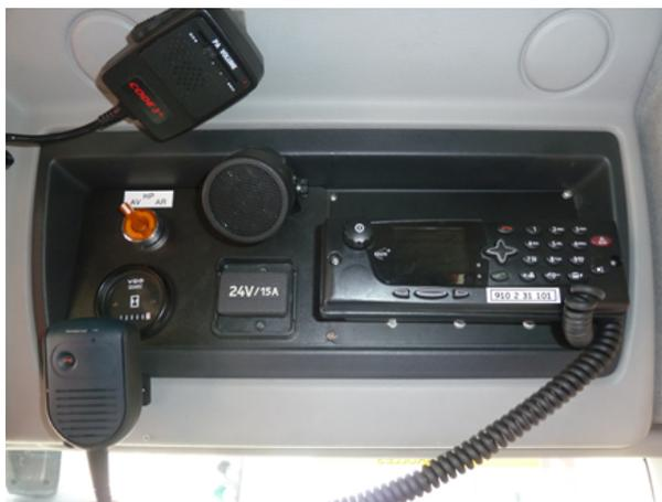
Les ERM permettent la transmission des statuts (signal numérique permettant un échange d'information relatif à l'état du véhicule) et la géolocalisation (position de l'engin).
