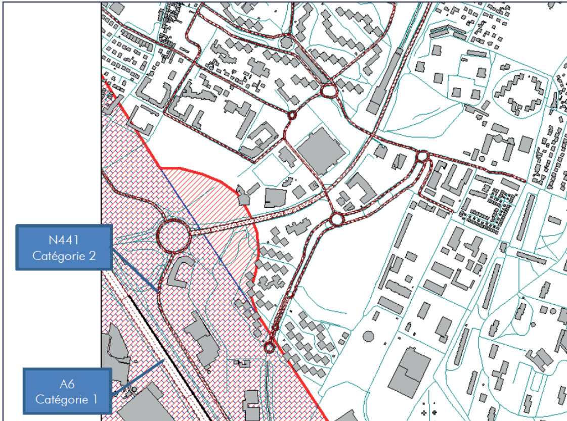
Figure 119 - Catégories des infrastructures terrestres voisines (Source : Acouplus, 10/2020)
