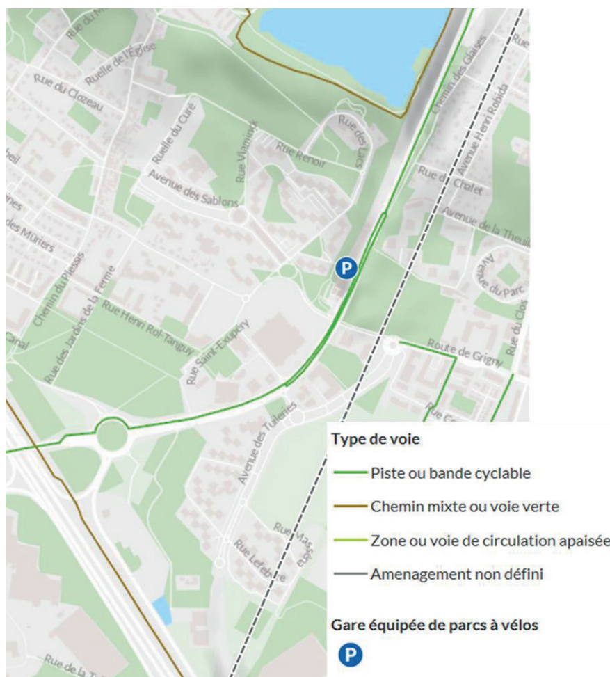
Figure 111 - Aménagements pour cycles sur le secteur de Grigny 2 (source : IAU)
